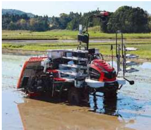
無人で植え付けをするロボット田植え機
